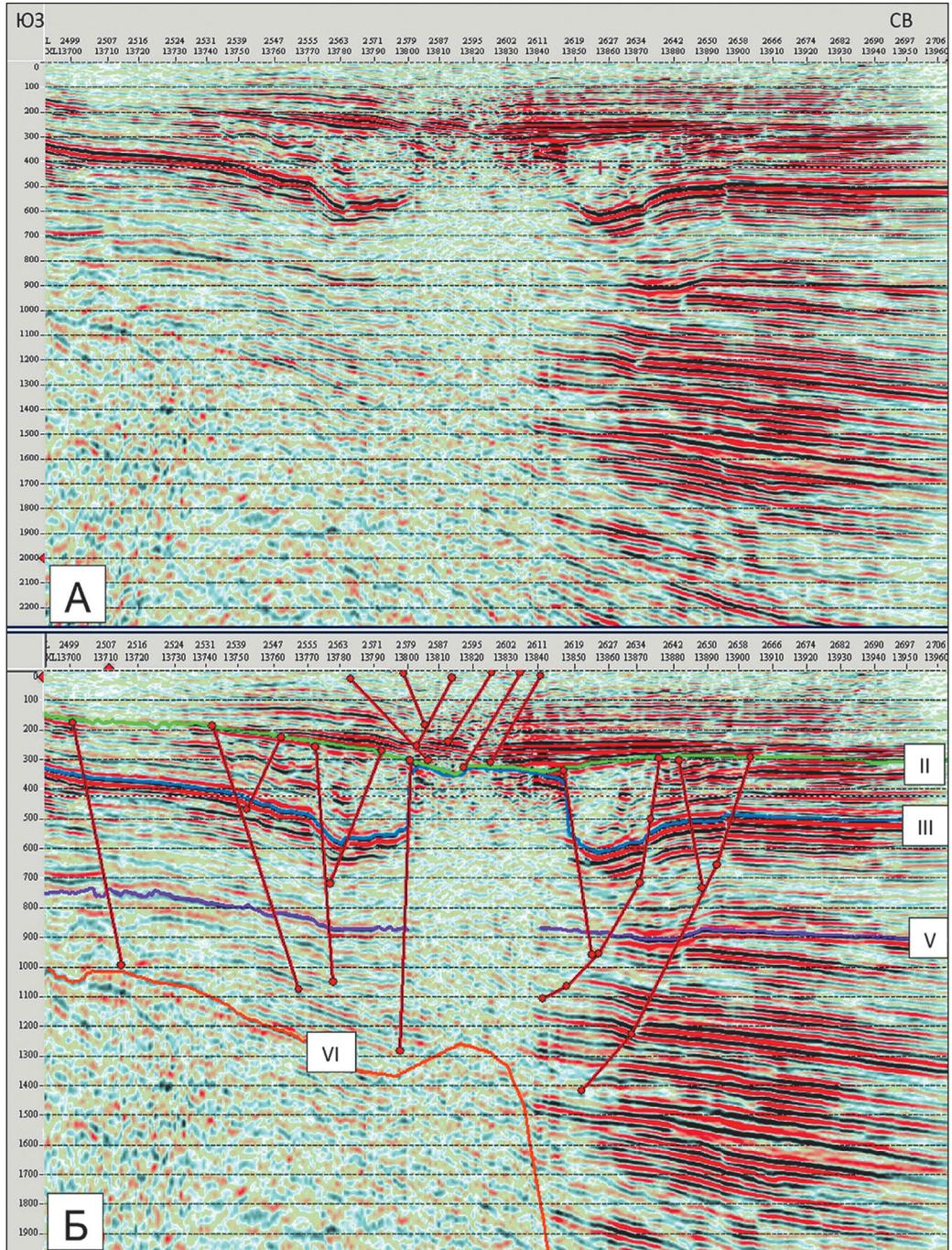
Рисунок 1 – Композитный сейсмический глубинный разрез через кольцевую структуру в надсолевых отложениях Прикаспийской впадины:
