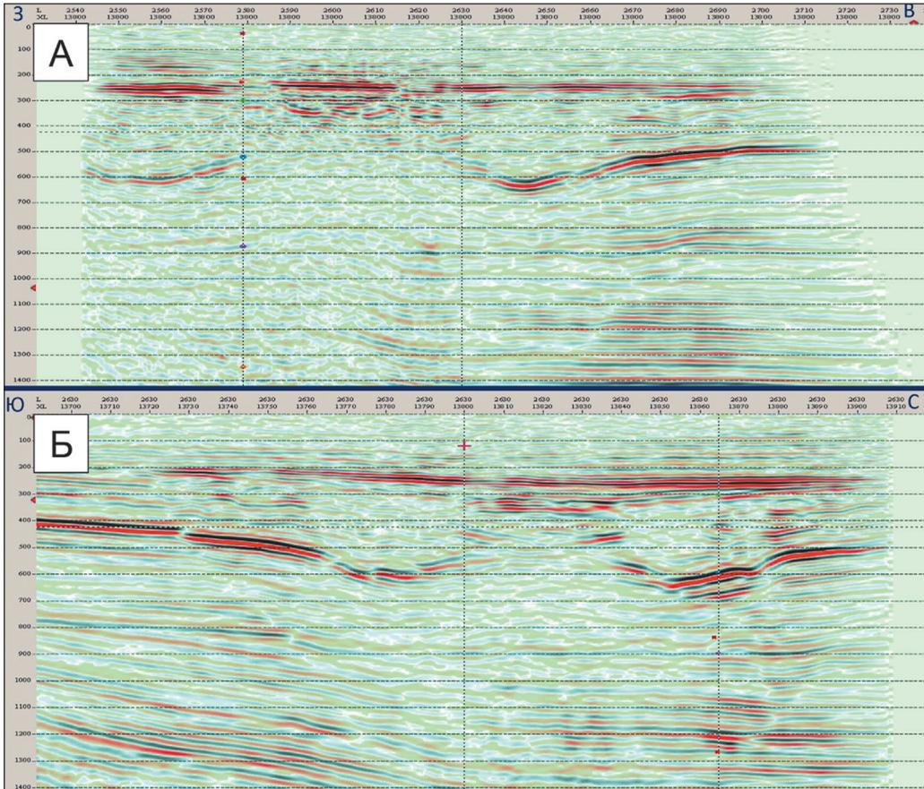
**Рисунок 7 – Глубинные сейсмические разрезы кросслайн (А) и инлайн (Б), пересекающие кольцевую структуру. Пересечение разрезов показано пунктирными вертикальными линиями, а их положение дано на рисунках 1, 3 и 5**
